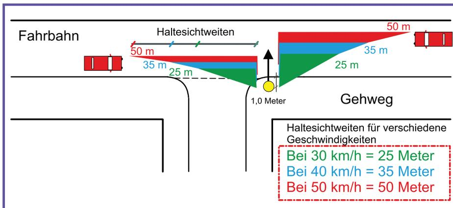
Skizze zur Überprüfung der Haltesichtweite an einer Überquerungsstelle (Draufsicht, unmaßstäblich).
