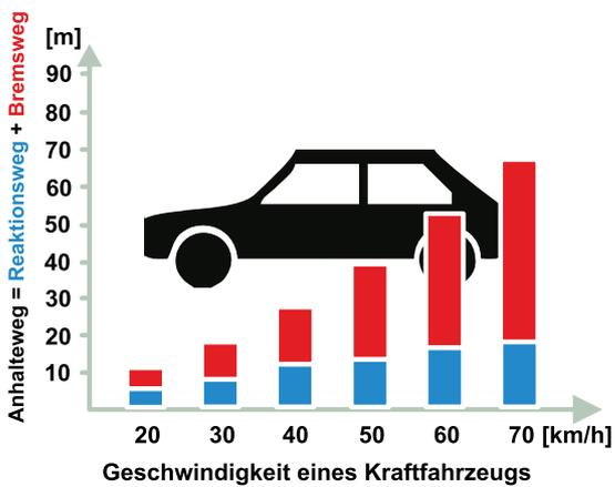
Die erforderliche Haltesichtweite ist abhängig von der zulässigen Geschwindigkeit für die Kraftfahrzeuge. Je höher die zulässige Geschwindigkeit ist, desto länger sind die erforderlichen Haltesichtweiten.
