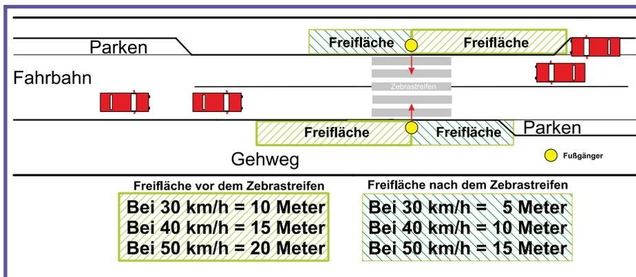
Beispielhafte Skizze für einen Zebrastreifen zur Überprüfung der frei zu haltenden Flächen an Überquerungsstellen. Die Werte gelten auch für Mittelinseln, Mittelstreifen oder Aufpflasterungen. (Draufsicht)
