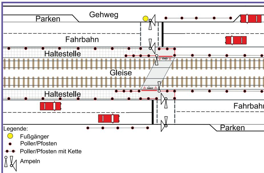
Skizze eines gesicherten Bahnübergangs mit Z-Führung (Draufsicht)
